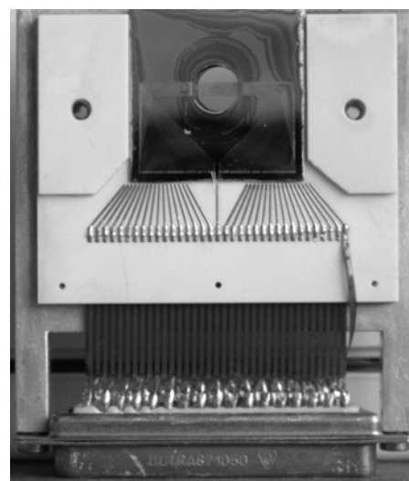
Рис. 8. Фото тришарового МСМД, розміщеного на керамічних монтажних платах у металевому корпусі.
